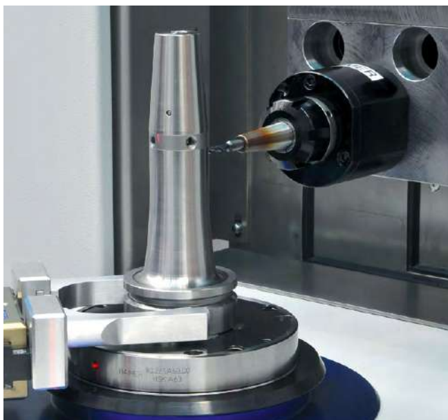
Automatische Beseitigung der Unwucht durch CNC-Bearbeitungseinheit Automated compensation of unbalance via CNC machining unit
