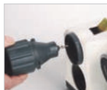
Ajuste de corte de la broca
