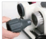
Afilado de la broca
